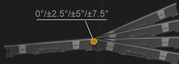
Can be adjusted  $0^\circ/\pm 2.5^\circ/\pm 5^\circ/\pm 7.5^\circ$  per unit
